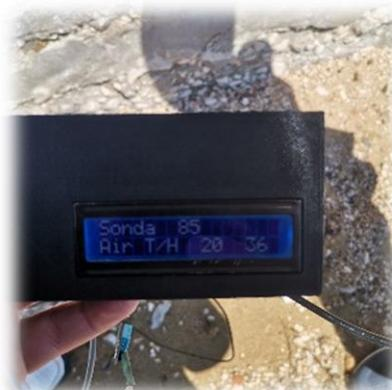
Slika 42. Termometar sa sondom
